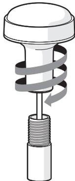
*Ilustración 7 Montaje de la antena de GPS*
